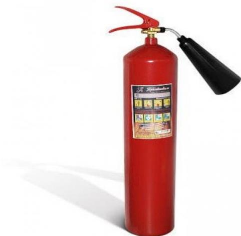
Эффект пламягашения в огнетушителях углекислотных достигается двояко: понижением температуры очага возгорания ниже точки воспламенения, и вытеснением кислорода из зоны горения негорючим углекислым газом.
